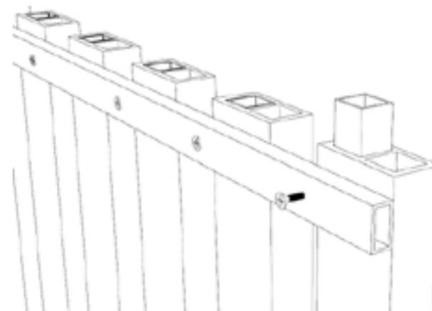
VENCE GRANDES VÃOS: ESTRUTURAÇÃO INTERNA COM PERFIL METÁLICO 25x25mm
